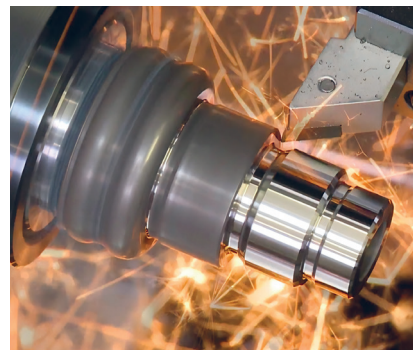
Tournage dur jusqu'à 65 ROCKWELL-HRC
