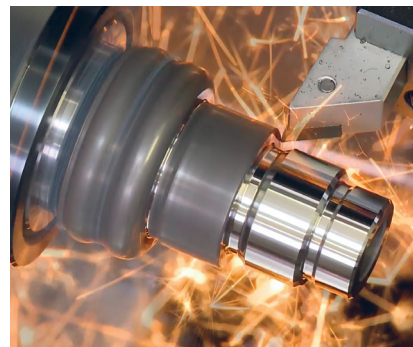
Tournage dur jusqu'à 65 ROCKWELL-HRC
