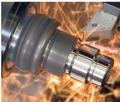
Tournage dur jusqu'à 65 ROCKWELL-HRC
